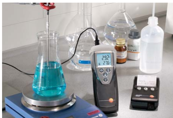
Precis temperaturmätning i industri och laboratorier med utskrift av mätdata på platsen
